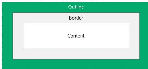
**outline** est un contour autour d'un élément pour marquer l'extérieur. Il n'est pas possible de distinguer les cotés supérieur, gauche, droite et inférieur.
